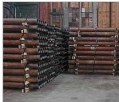
Encoframientos machos y hembras cortados y atados conforme a las especificaciones
